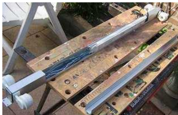
Foto 3: Hier de nog open goot met het gemonteerde nieuwe evsa.
